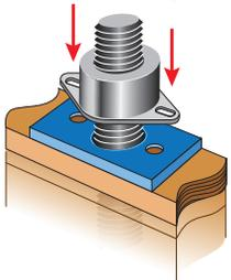
**Paso 3.** Deslice la tuerca de ajuste de manera pareja por la varilla roscada hasta que esté completamente emplazada sobre la arandela de la placa de asiento.
