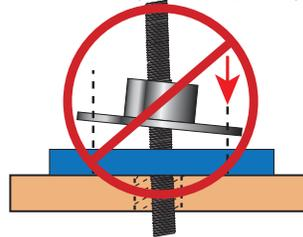
**INCORRECTO** - Orificio demasiado grande, la varilla supera los niveles de tolerancia de desnivel.
