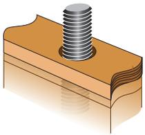
**Paso 1.** Taladre un orificio de un mínimo de 1/2 pulgada más grande que el diámetro de la varilla roscada e insértela.
