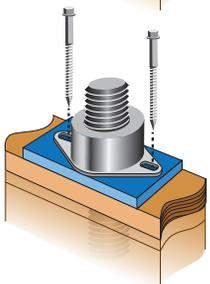
**Paso 5.** Inserte los tornillos MiTek® Pro Series™ como se muestra.
