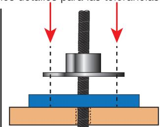
**CORRECTO** - Orificio taladrado de 1/2" más grande que el diámetro de la varilla y se aplica igual presión para asentar completamente la tuerca CNX / CNXO en la arandela.
