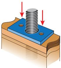
**Paso 2.** Deslice la arandela de la placa de asiento sobre la varilla roscada y empujela hacia abajo hasta que esté completamente emplazada sobre el marco de madera.
