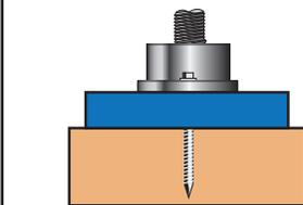
**CORRECTO** - El tornillo está insertado a plomo (nivelado correctamente).
